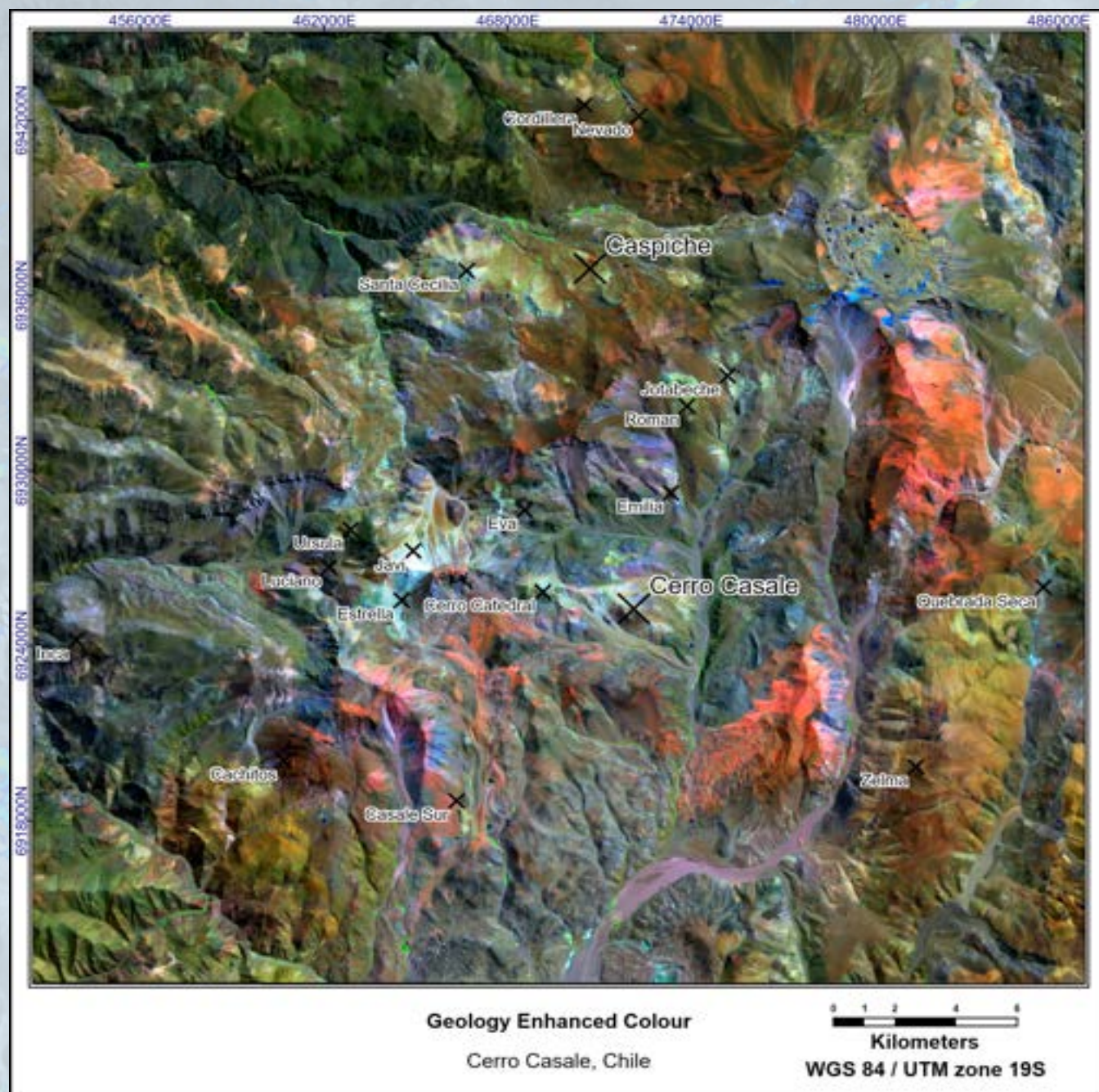
Figura 25. Imagen en Color Realzada para Geología. Imagen RGB que combina bandas VNIR y SWIR para resaltar mejor los cambios en las litologías y la alteración no visible en la imagen en color.
