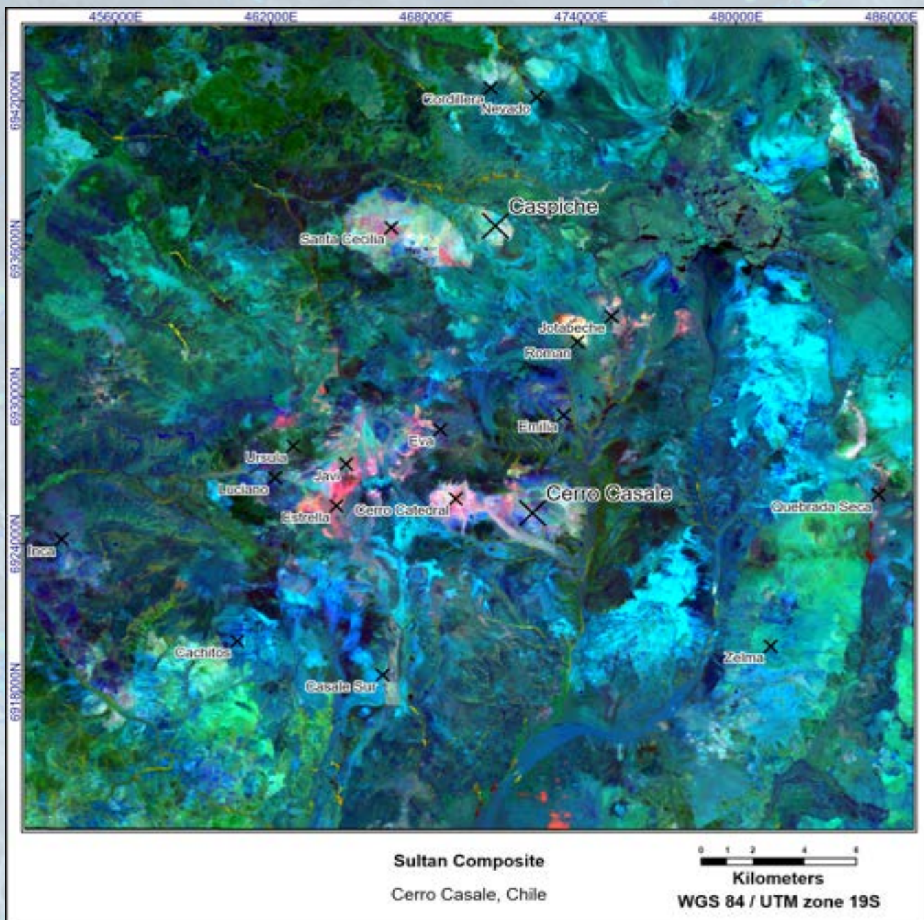
Figura 28. Composición Sultan. Imagen compuesta en RGB que utiliza una combinación de índices espectrales para resaltar mejor la variación en litologías primarias y minerales de alteración.
